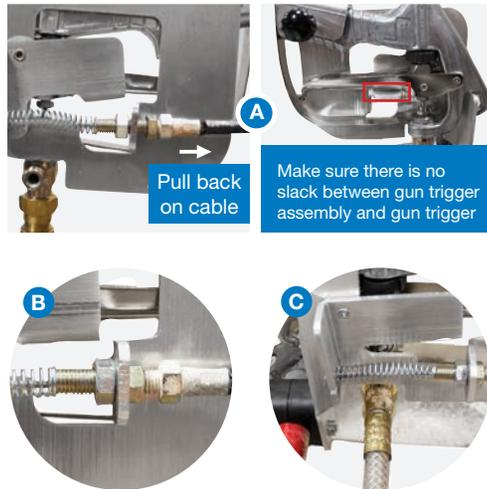
**DO NOT OVER-TIGHTEN. MAKE SURE THE NOZZLE TIP IS ALIGNED HORIZONTALLY WITH THE GROUND.**
